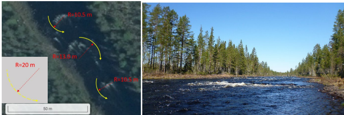
Figur 5 Onaturlig huvudströmfåra med för skarpa kurvor i område 2 strax uppströms Kanalen. Bryts upp så att en ca 5 m bred huvudströmfåra med kurvradie >20 m bildas. Bilden till höger tagen vid lägre vattenstånd vid armarna uppströms de i vänstra bilden. Minsta möjliga åtgärd kan vara att öppna upp längs ena stranden för att skapa en rak huvudströmfåra förbi hindren.
